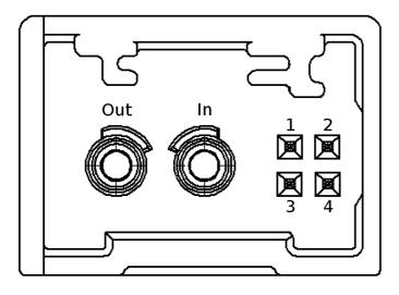
Out: optical output (MOST25) In: optical input (MOST25)
